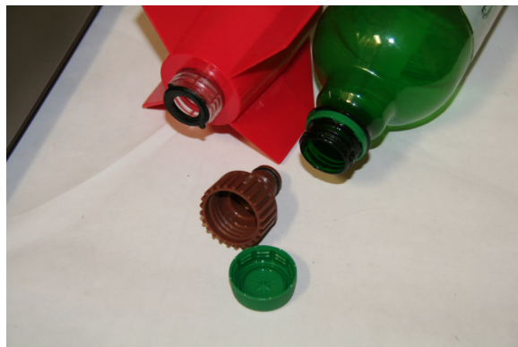
Slika 1: Vodna raketa, plastena in navoj pretvornika
